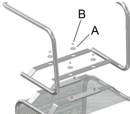
Capovolgere la struttura e sistemarla base a slitta in corrispondenza dei fori. Inserire le rondelle (A) nelle viti e fissare con i bulloni (B)
